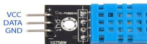
Fig 5 DHT11 Sensor
